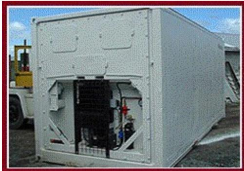
Ce sont les containers où est incorporé une unité réfrigérante, qui peut être de type mécanique ou cryogénique. Dans le premier cas, il s'agit d'un moteur à combustion interne ou actionné par une prise de courant électrique.
